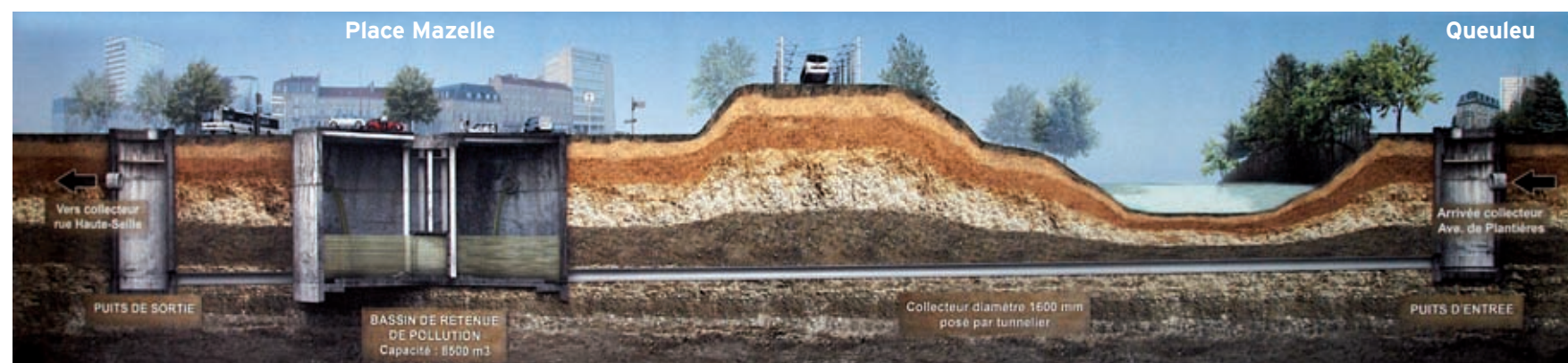
Vue en coupe du bassin souterrain de stockage des eaux pluviales © Haganis
